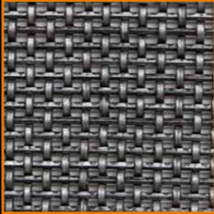
Tela metálica destinada a la extracción del germen por el rozamiento del trigo.
